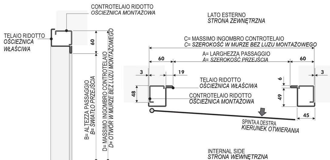
MISURE PER TELAIO RIDOTTO +
