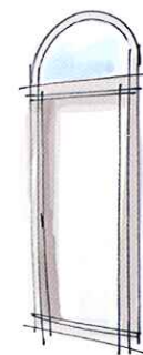
DRZWI JEDNOSKRZYDŁOWE Z NAŚWIETLEM GÓRNYM ŁUKOWYM
